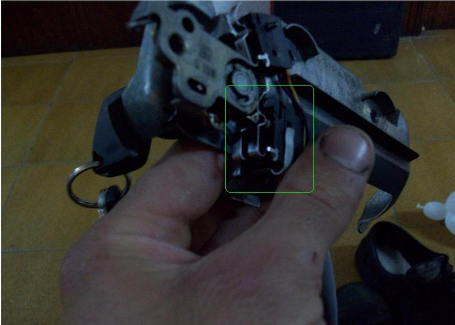
*Si no encontramos un micro de dos cables sencillo, podemos utilizar uno de tres cables, utilizando únicamente 2 cables, los correspondientes a los bornes 1 y 2, o lo que es lo mismo, los cables rojo-amarillo y azul-negro, conectando uno de ellos a masa y el otro a su correspondiente lugar, no importa cual de los dos conectemos a masa.*
