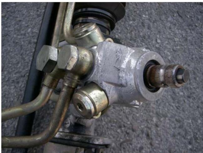
La foto de la derecha muestra el eje de la dirección asistida, esta es de un Kadett en concreto, la del Astra es diferente así que deberéis usar el usillo apropiado, el que venía con la dirección asistida que cojáis. Cuidado, debéis poner el usillo nuevo en la columna de la dirección ANTES de poner la caja asistida en su sitio, lo subís hacia arriba a la espera del vástago de la dirección asistida.
