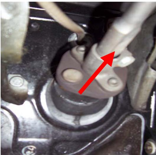
Descubriremos el vástago de la dirección, la operación para el montaje lógicamente será a la inversa. Esta es la caja manual y podéis ver el vástago del que hablamos. (Flecha).
