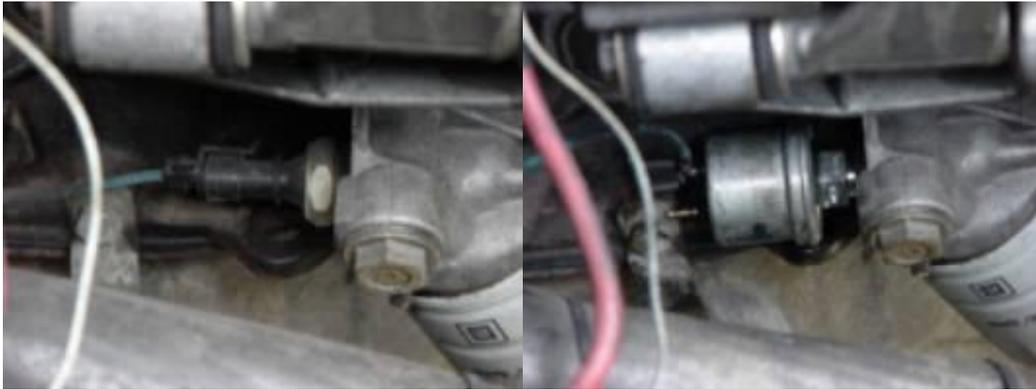
No caso do 4.1 o interruptor do sensor não será substituído. A um palmo a esquerda existe um parafuso na parede do bloco (logo acima do calço do motor). Este parafuso será removido e colocado um adaptador (o mesmo que existe no interruptor do 4.1). E neste adaptador irá o sensor (1-5 bar) de um contato no qual irá o fio proveniente do painel digital.
