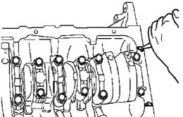
1) Filetear de nuevo la rosca antes de utilizarla de nuevo y montar los tornillos con tornillos microencapsulados (rojos).
