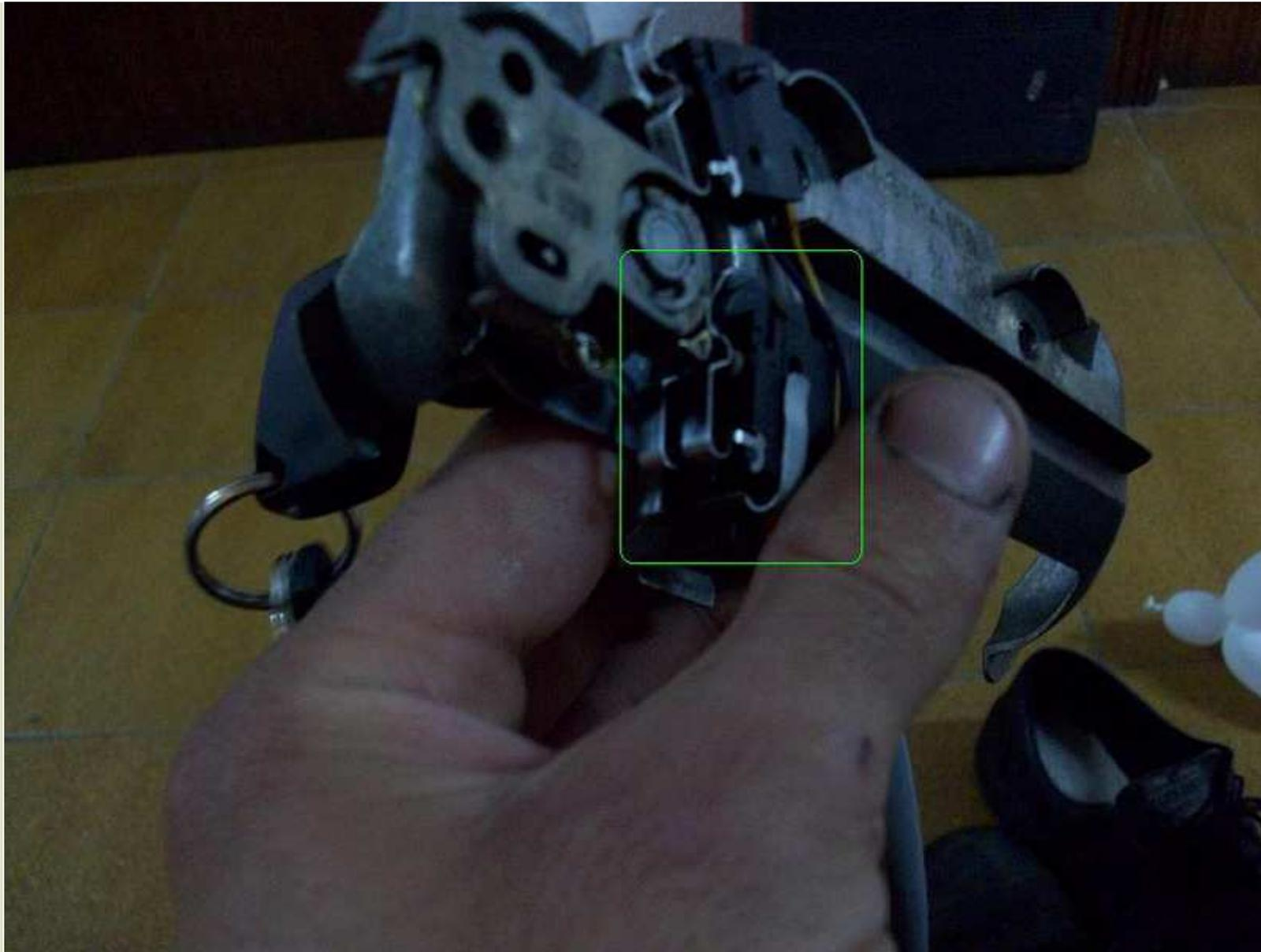
Si no encontramos un micro de dos cables sencillo, podemos utilizar uno de tres cables, utilizando únicamente 2 cables, los correspondientes a los bornes 1 y 2, o lo que es lo mismo, los cables rojo-amarillo y azul-negro, conectando uno de ellos a masa y el otro a su correspondiente lugar, no importa cual de los dos conectemos a masa.
