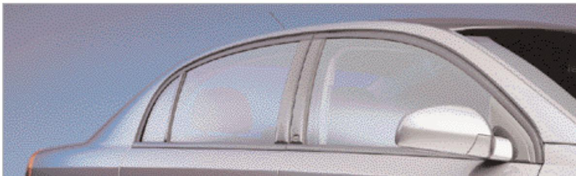
Placas vitro, 8 piezas; triángulo de retrovisor delantero, pilar B y guía cristal trasero, i34 17 045.
