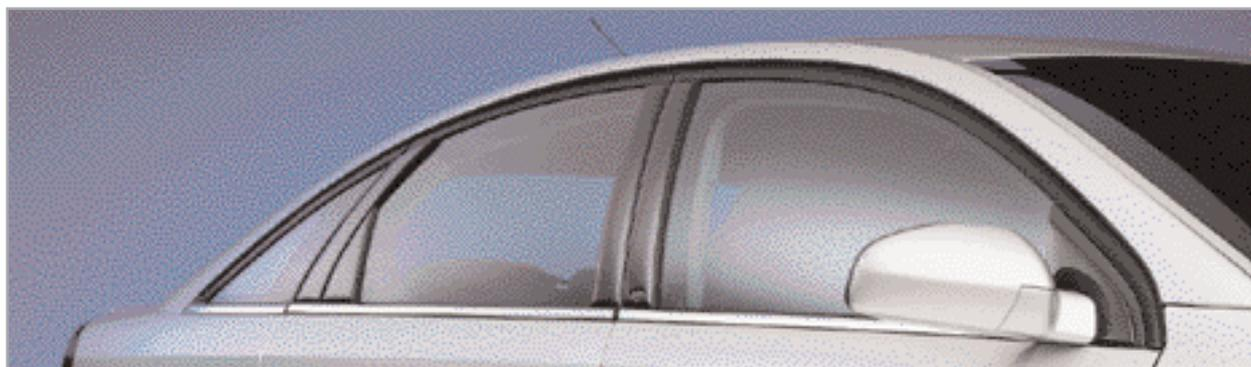
Placas vitro, 10 piezas; triángulo de retrovisor delantero, pilar B y guía cristal trasero, i 34 17 046.
